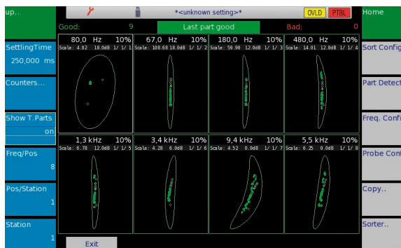
Sortiermodus „BubbleGate“ im neuen Q500 Modul
