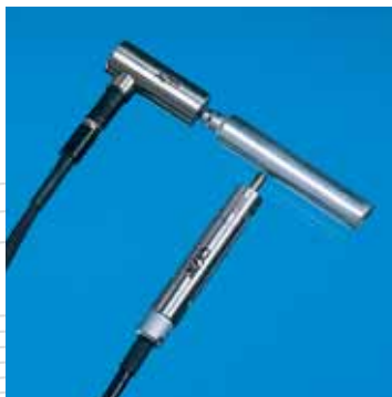
Schichtdicken- und Porenprüfung an Alu-Tuben
