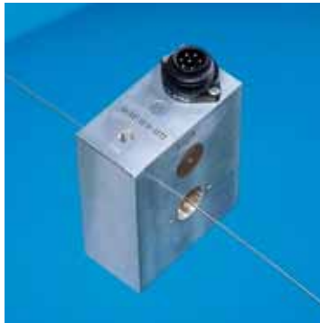
Längs- und Querfehler an Feindrähten
