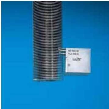
Grund- und Flankenfehler an hochberippten Rohren
