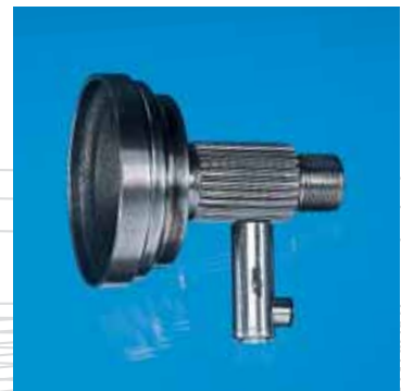
Risserkennung im Zahngrund, berührungslos
