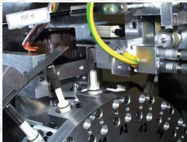
Anlage zur Rissprüfung an Tiefziehhülsen
