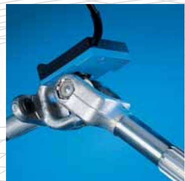
Verdeckte Risse an Sicherheitsteilen
