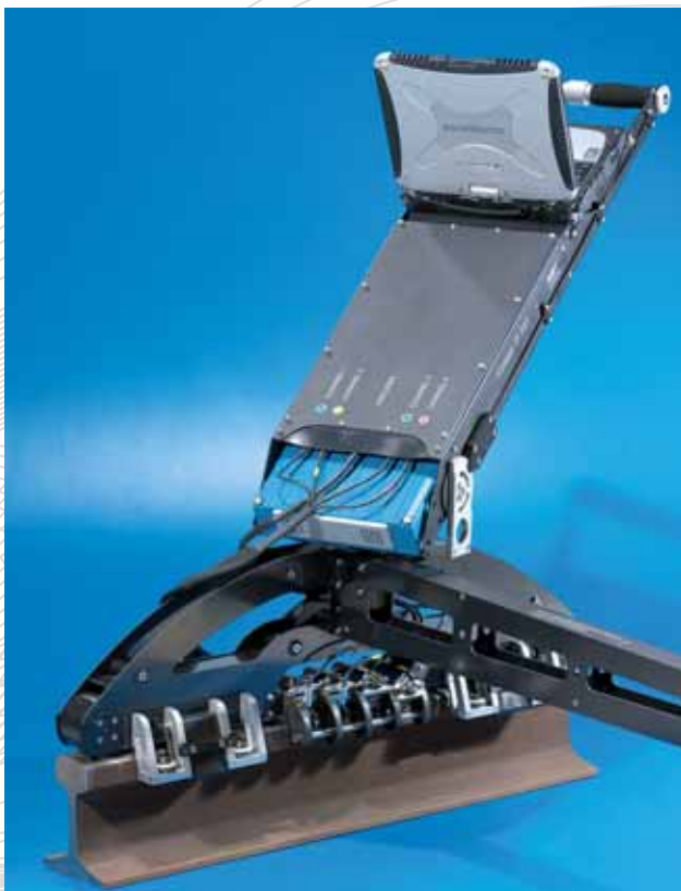
Draisine D300 in Arbeitsstellung
