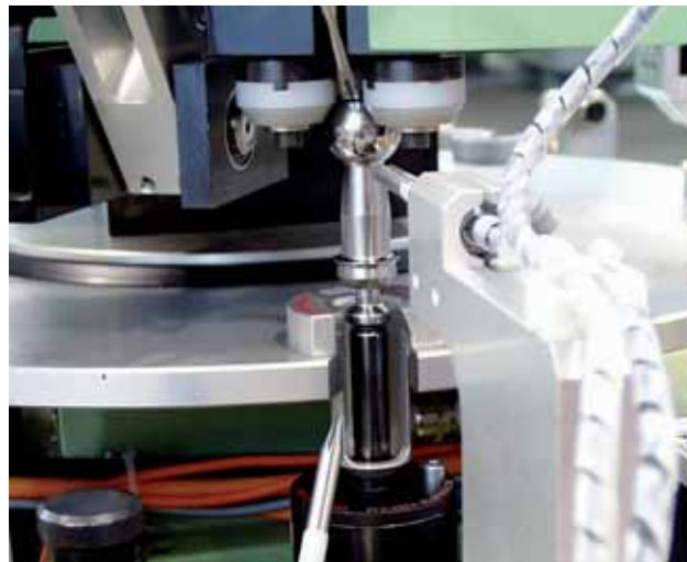
Anlage zur vollautomatisierten Rissprüfung an Kugelzapfen
