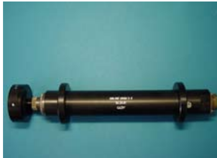
IHR40/2-2 Rotor mit im Durchmesser verstellbarem Sensor
