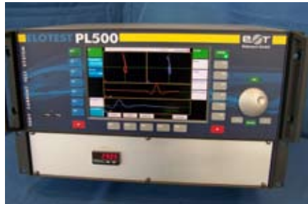
In-Line Wirbelstromprüfgerät ELOTES PL500/LP
