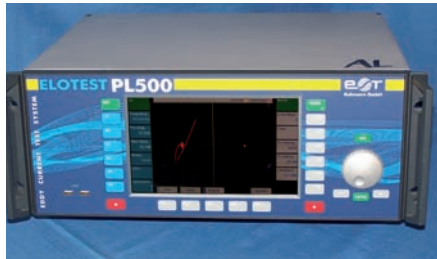
In-Line Wirbelstromprüfgerät ELOTES PL500/LP
