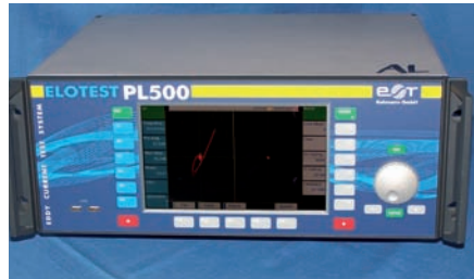
In-Line Wirbelstromprüfgerät ELOTTEST PL500/LP
