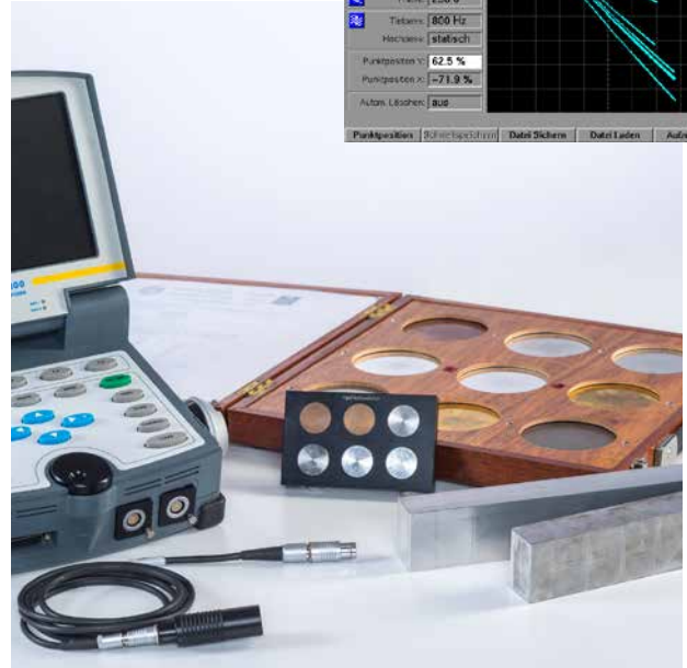
Leitfähigkeitsprüfung – Messung der Leitfähigkeit nicht ferromagnetischer Metalle und Schichtdickenmessung
