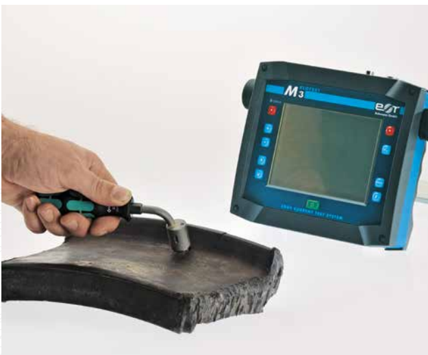
Prüfset für raue Umgebungsbedingungen mit Riss-Indikation direkt am Sensor über LED
