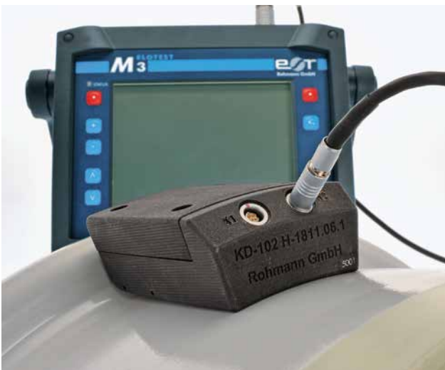
Manuelle Oberflächenrissprüfung mit angepasstem Kontursensor
