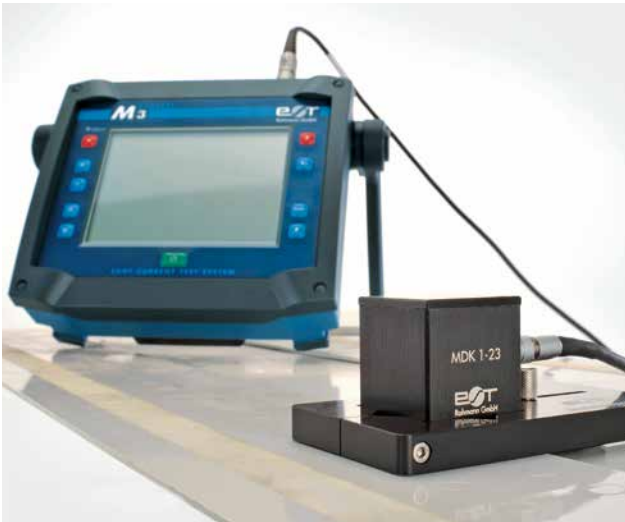
Prüfung auf verdeckte Risse in Aluminium-Nietstrukturen
