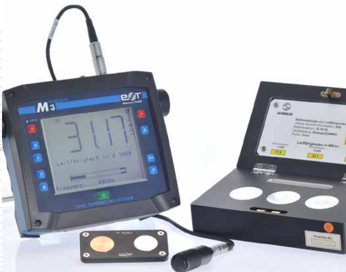
Leitfähigkeitsmessung in IACS oder MS/m von 1 % bis 110 % IACS
