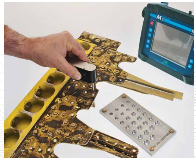
Bohrungsprüfung mit Minirotor an Aluminiumstrukturen
