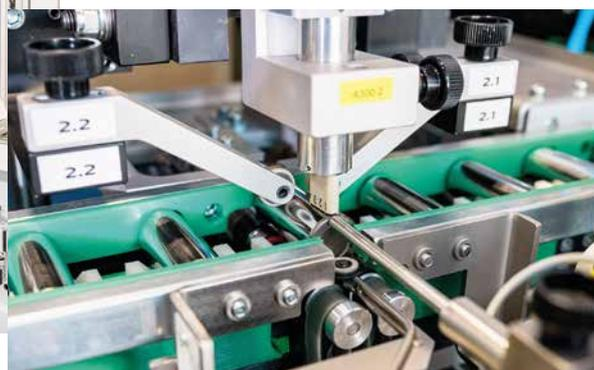
Automatisierte Riss- und Schleifbrandprüfung an Wälzkörpern mit dem ELOTEST PL650 und Prüfsonden (Typ KD-129 und KDA-129).
