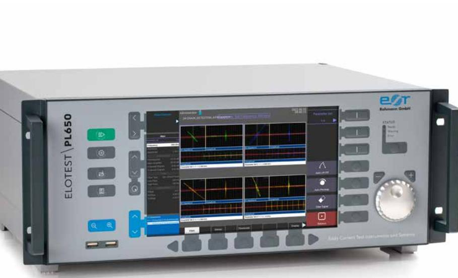
Je nach Anwendung ist das ELOTEST PL650 in verschiedenen Gehäuseformen erhältlich. Einsatzbereiche sind u.a. präzise Materialsortierung sowie Riss- und Schleifbrandprüfung.
