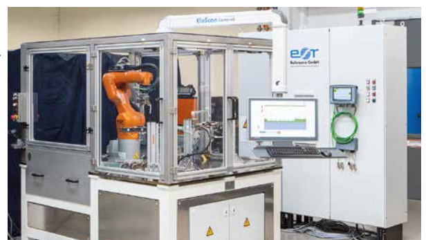
Roboter-gesteuerte Prüfanlage mit ELOTEST PL650, ELO\SCAN und Auswertesoftware ELO\IMAGE.
