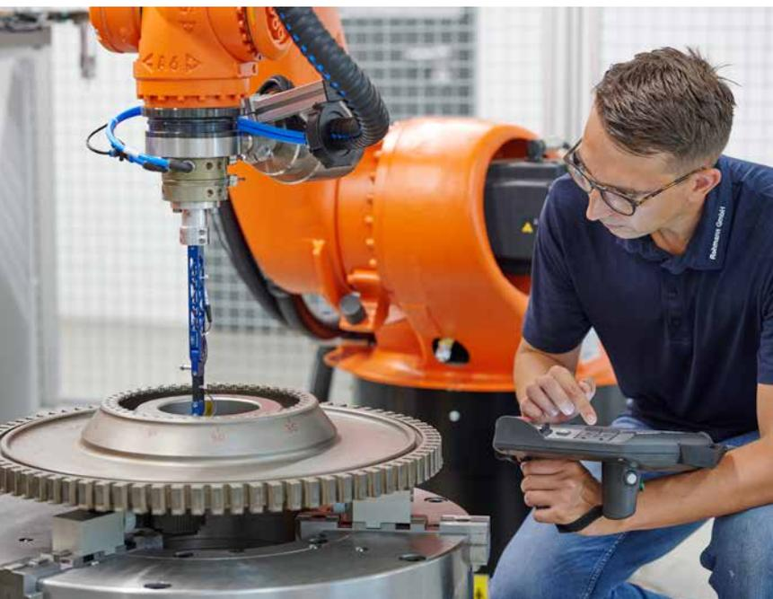
Prüfung mit dem „Blue-Tool“ – flexibel einstellbar.
