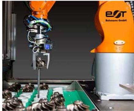
ELOSCAN Compact für die Prüfung von Turbinenrädern in der Automobil-Industrie.
