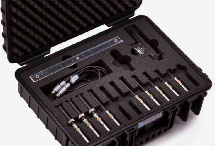
Schaftverstellbare Sonden mit optionalem Zubehör
