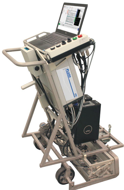
Mobiler Prüfwagen ELOTEST HST 3 mit 64 Sensoren zur Erkennung von Hard Spots, mit Wirbelstromprüfgerät ELOTEST PL600 (Bild: Rohmann)
